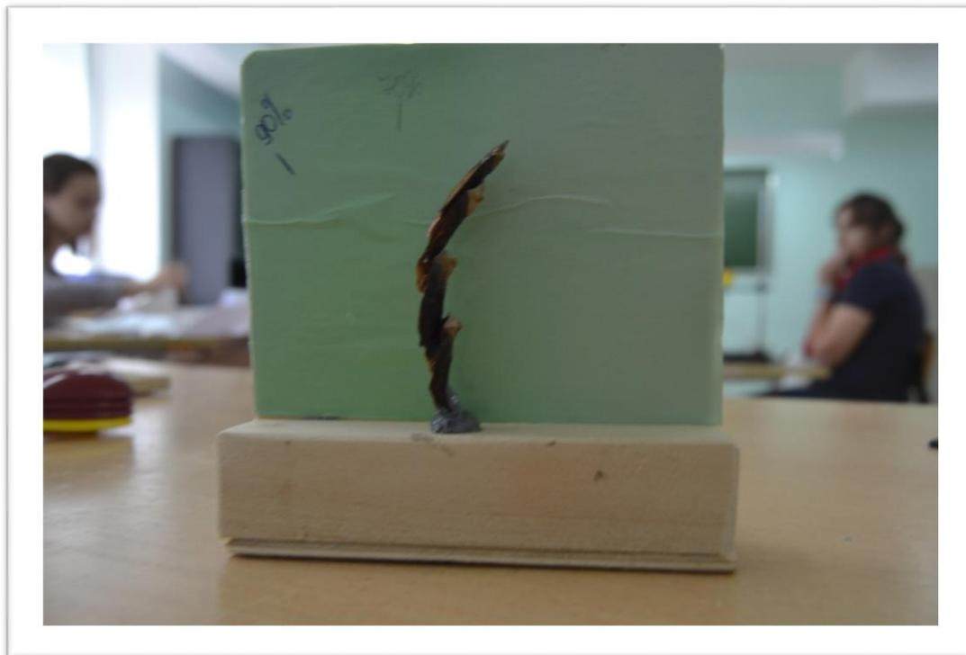
Гигрометр — измерительный прибор, предназначенный для определения влажности воздуха и других газов. Существует несколько классов гигрометров. Для изготовления гигрометра нам понадобилось: брусочек дерева, шишка, эпоксидный клей.
