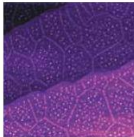
Рис. 4.7. АСМ-изображение самоорганизации наноостровков кремния; размер 3,2 \times 3,2 мкм. Авторы: Е. Е. Родякина и др. (Институт физики полупроводников СО РАН, Москва, Россия)
