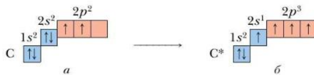
Рис. 9. Схема состояния атома углерода: а — основное состояние; б — возбуждённое состояние
