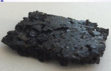
Образец материала, полученного склеиванием резиновой крошки после сбора нефтяного загрязнения.
