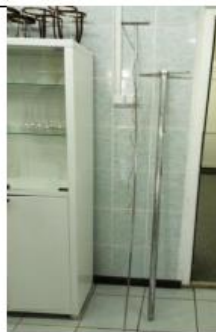
Рисунок 4. Шип для отбора проб
