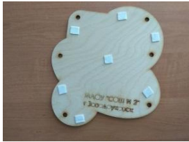
Рисунок 3. Двусторонний скотч на фанере
