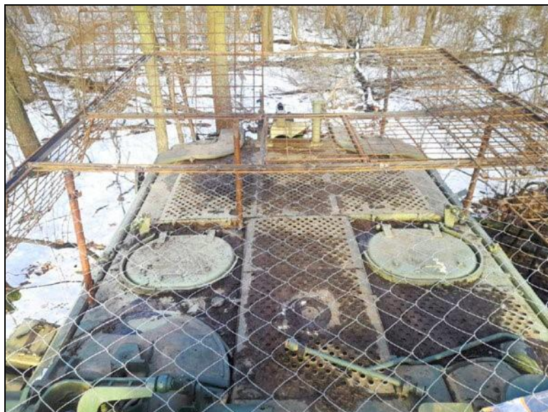
Рис. 8. Защита бронетехники из сетки-рабицы от сбросов и простейших FPV-дронов камикадзе
