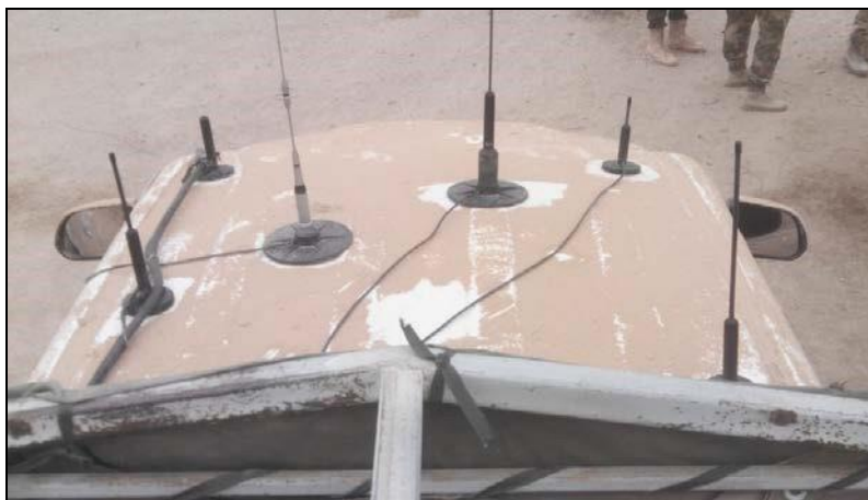
Рис. 12. Размещение станции помех «Лесочек» на капоте автомобиля
