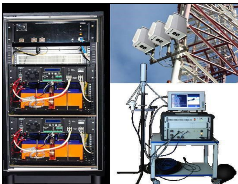
Рис. 15. Средства комплекса "Поле-21": стойка с аппаратурой (слева), антенные модули (справа сверху) и пульт управления
