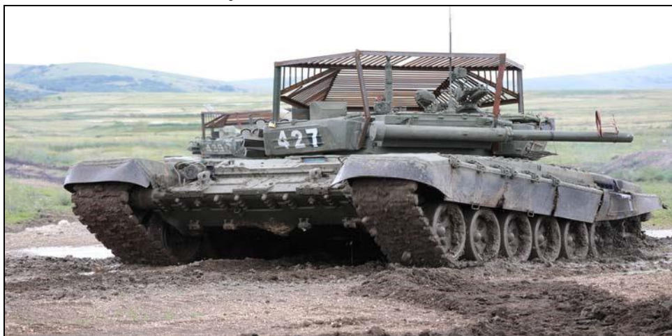
Рис. 7. Танк с защитным стальным козырьком
