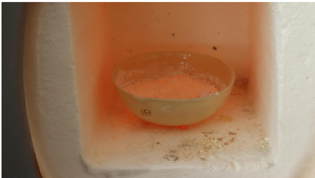
Рисунок 3. Процесс нагрева шихты в муфельной печи
