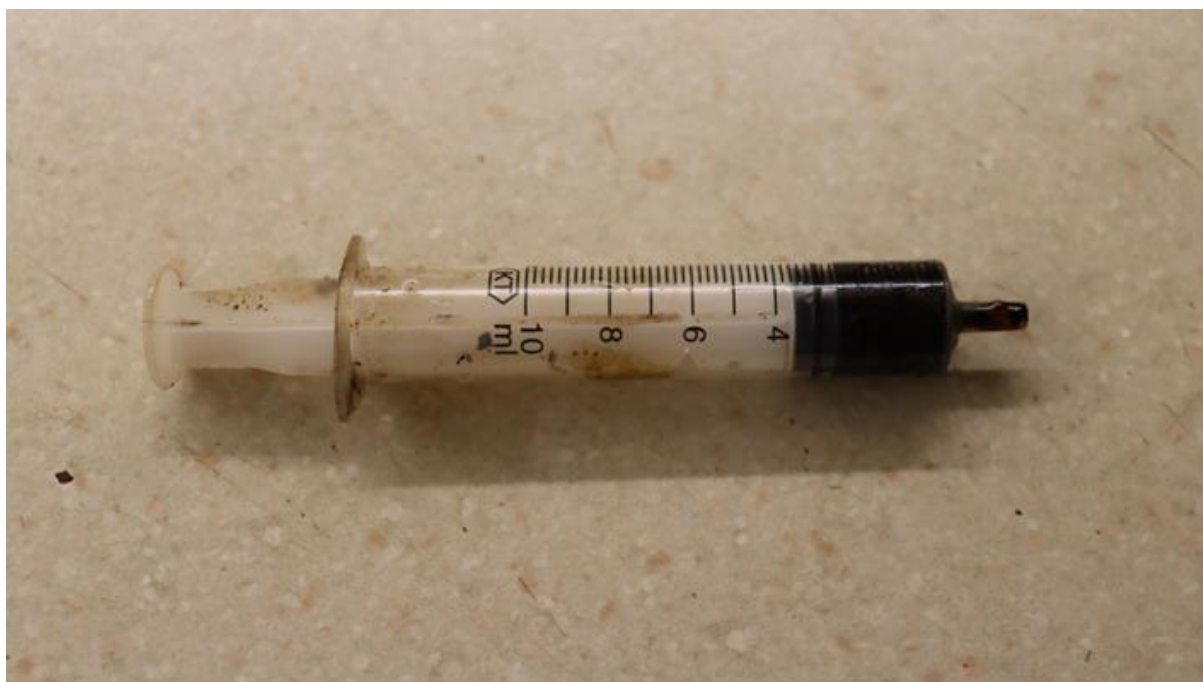
Рисунок 4. Экстракция нефти из листового опада в рамках проекта осуществлялась выдавливанием через шприц.
