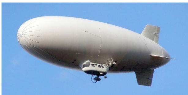
БПЛА аэростатического типа
