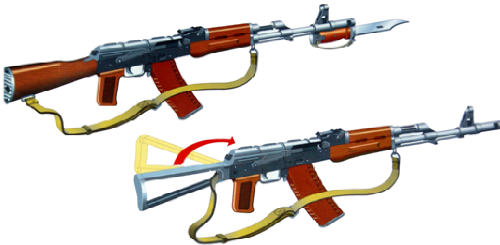
Рис. 2.1. Автомат Калашникова: а – АК-74М; б – АКС-74
