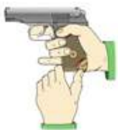
Рис. 2.40. Извлечь магазин из основания рукоятки
