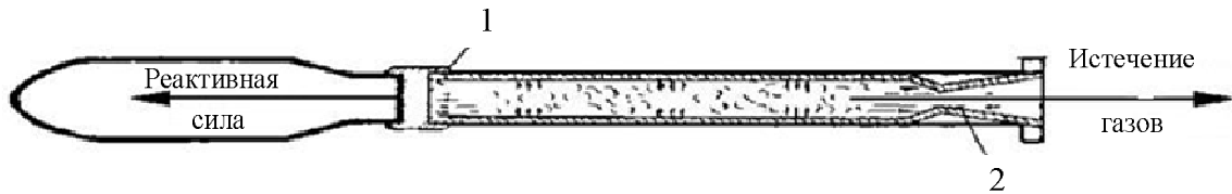
Рис. 1.3. Образование реактивной силы при действии реактивного двигателя гранаты: 1 – передняя стенка реактивного двигателя; 2 – сопло
