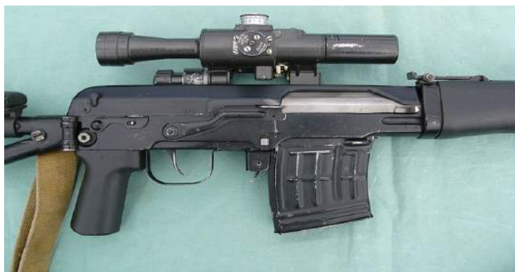
Рис. 2.33. Ствольная коробка с магазином и оптическим прицелом
