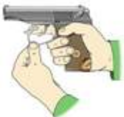
Рис. 2.41. Оттянуть спусковую скобу
