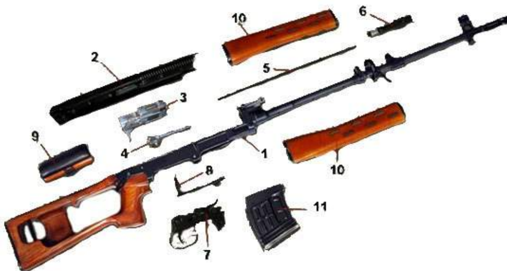
Рис. 2.32. Основные части и механизмы снайперской винтовки: 1 – ствол со ствольной коробкой, открытым прицелом и прикладом; 2 – крышка ствольной коробки с возвратным механизмом; 3 – затворная рама; 4 – затвор; 5 – толкатель с пружиной; 6 – газовый поршень; 7 – ударно-спусковой механизм; 8 – предохранитель; 9 – щека приклада; 10 – ствольная накладка; 11 – магазин
