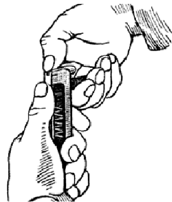
Рис. 2.44. Снаряжение магазина патронами
