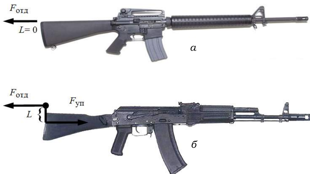
Рис. 2.28. «Прогрессивная» (М16) – а и «классическая» (АК-74) – б компоновочные схемы
