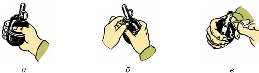
Рис. 3.10. Действия перед метанием ручной осколочной гранаты: а – прижатие спусковой скобы к корпусу гранаты; б – выпрямление концов предохранительной чеки; в – выдергивание предохранительной чеки
