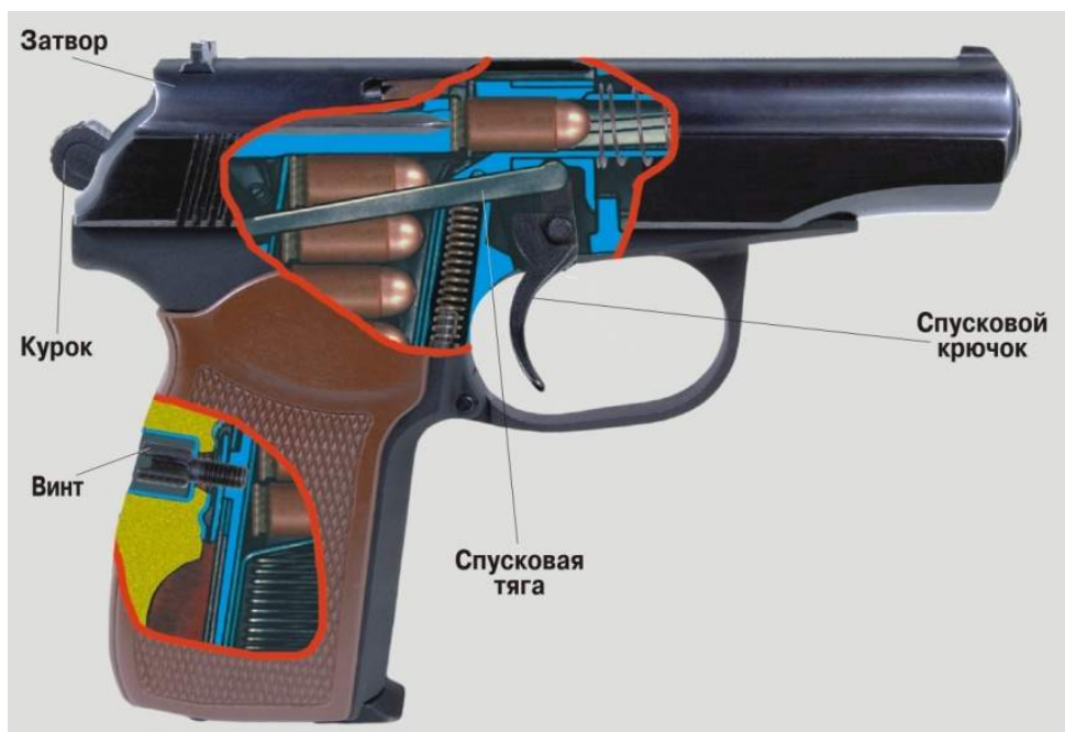
Рис. 2.38. Положение частей и механизмов перед выстрелом в момент спуска курка с боевого взвода пистолета ПМ
